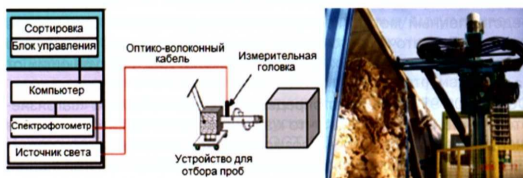
Рис. 1. Схема процедуры отбора пробы с применением системы СТР.
